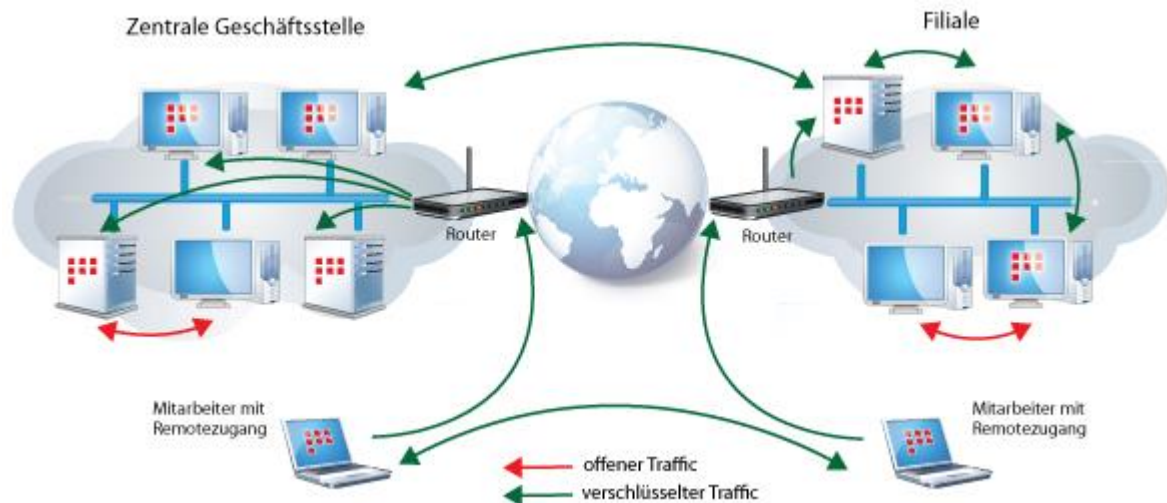
Abbildung 10. Aufbau eines VPN-Netzwerks auf Basis der ViPNet-Technologie
