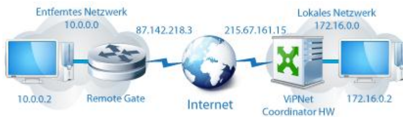
Abbildung 2: Aufbau von Verbindungen über das IPsec-Protokoll
