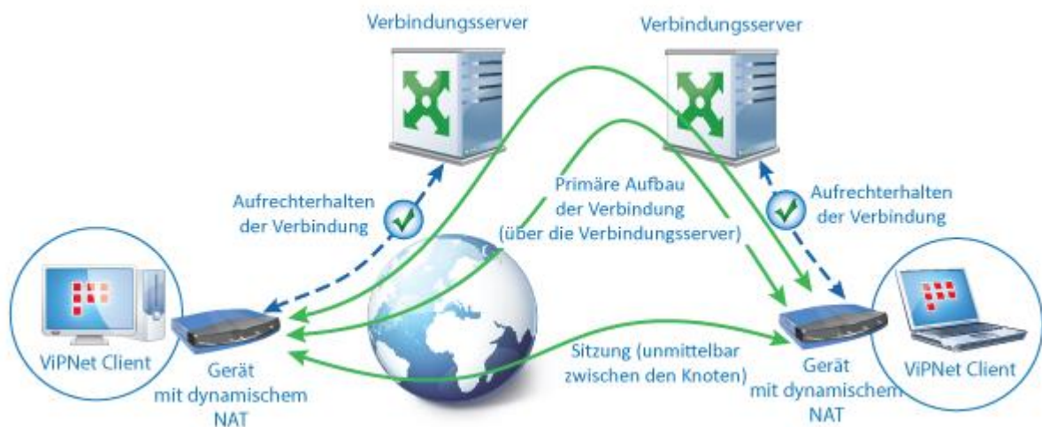
Abbildung 2. Kommunikation der Netzwerkknoten
