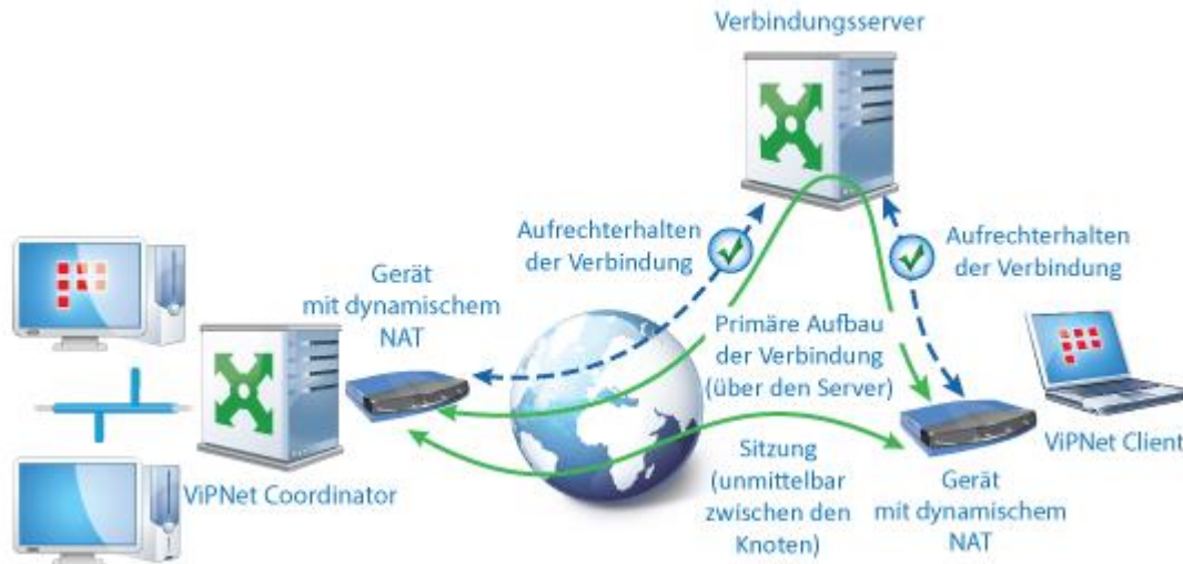
Abbildung 8. Verbindung über eine Firewall mit dynamischem NAT
